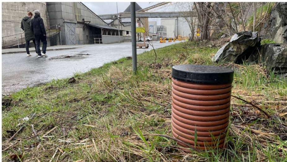
TESTBRØNN: Det kan sjå ut som eit avløpsrør, men dette er ein testbrønn som går over 200 meter ned til grunnfjellet på Ladehammeren i Trondheim – der fjernvarme skal lagrast.
